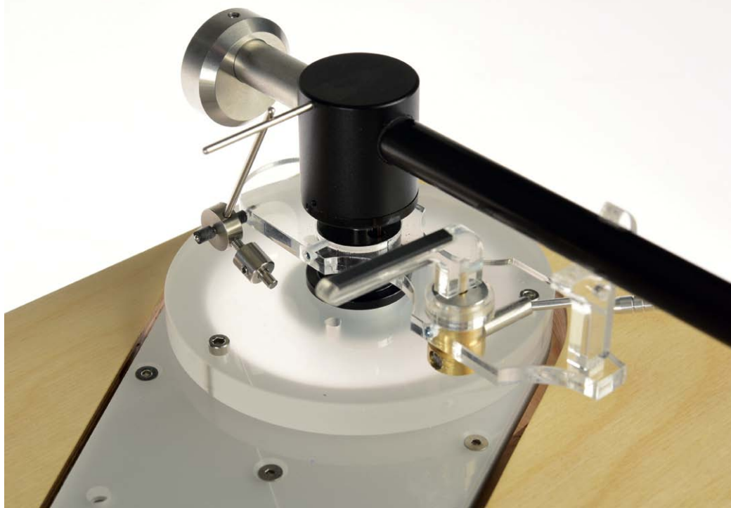
Das Antiskating funktioniert über ein auf einen Arm-Ausleger wirkendes Gewicht. Das Arm-Gegengewicht sitzt wegen der geringen geforderten Auflagekraft des v.d.H. MCs recht weit hinten auf dem Rohr.
